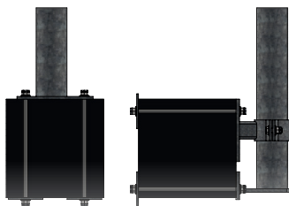
FIXATION PAR AUTOFOREUSE SUR BAC SEC
