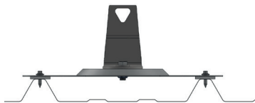
FIXATION PAR AUTOFOREUSE SUR BAC SEC
