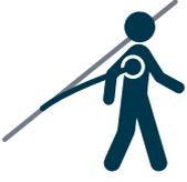
Système destiné à limiter les mouvements de l'utilisateur afin de l'empêcher d'atteindre des zones à risque de chute. Il n'est pas capable d'arrêter une chute ni d'avoir la fonction de maintien au travail ou de suspension.
