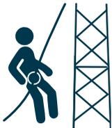
Système conçu pour travailler suspendu dans le vide grâce au point d'attache ventrale. L'utilisateur n'étant plus en appui sur ses pieds, la charge est répartie au niveau de la ceinture et des cuisses du harnais. Composé d'un point d'ancrage, d'un harnais anti-chute, d'un dispositif anti-chute (longe avec absorbeur d'énergie ou corde avec antichute bloqueur coulissant ou enrouleur) et d'un dispositif de progression.
