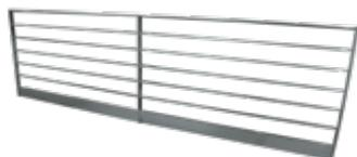
Dimensions 3200x1200 mm: la barrière, avec sa plinthe et ses lisses obligatoires, permet de sécuriser en une seule fois et sans manipulation spécifique 3 mètres linéaires de chantier.
